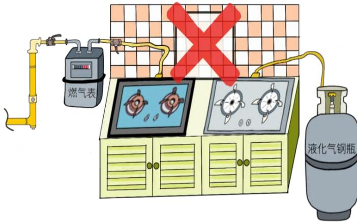
5. 燃气具连接软管可选用不锈钢波纹软管、金属包覆软管、橡胶复合软管，应标有产品名称、执行标准、有效使用期等基础信息，软管应在有效使用期限内使用。软管长度不应超过 2 米，中间不得有接头、三通，不得穿越墙体、门窗、顶棚和地面等。
