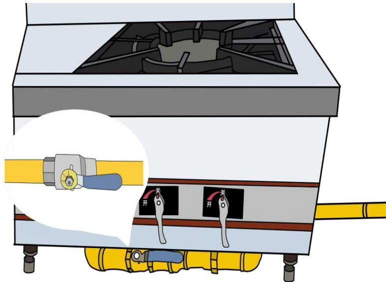
7. 燃气具连接软管可选用不锈钢波纹管、金属包覆软管、橡胶复合软管，软管上应标有产品名称、执行标准、有效使用期等基础信息，软管应在有效使用期限内使用。软管长度不应超过 2 米，中间不得有接头、三通，软管不得穿越墙体、门窗、顶棚和地面等。
