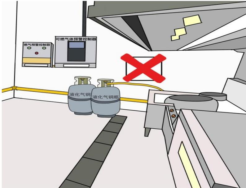
11. 用气场所须安装符合要求的可燃气体报警器，探测器应设置在顶棚或距顶棚小于 0.3 米的墙上。
