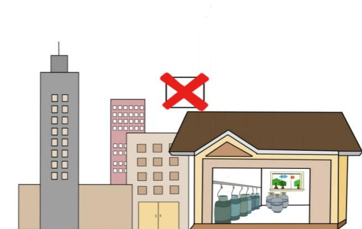
9. 瓶组间高度应大于 2.2 米，应地势平坦，内部不得有暖气沟，地漏及其他地下构筑物，外部应当张贴明显安全警示标志及燃气经营企业应急抢修电话。
